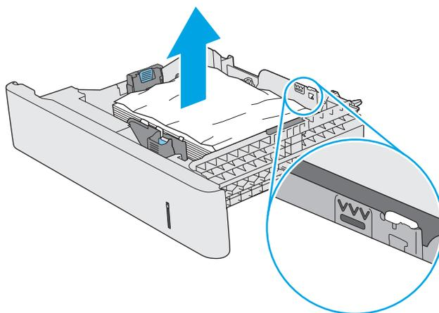
10. Remova qualquer papel dos cilindros de alimentação de dentro da impressora. Primeiro, puxe o papel para a esquerda para liberá-lo e, então, para frente para removê-lo.
