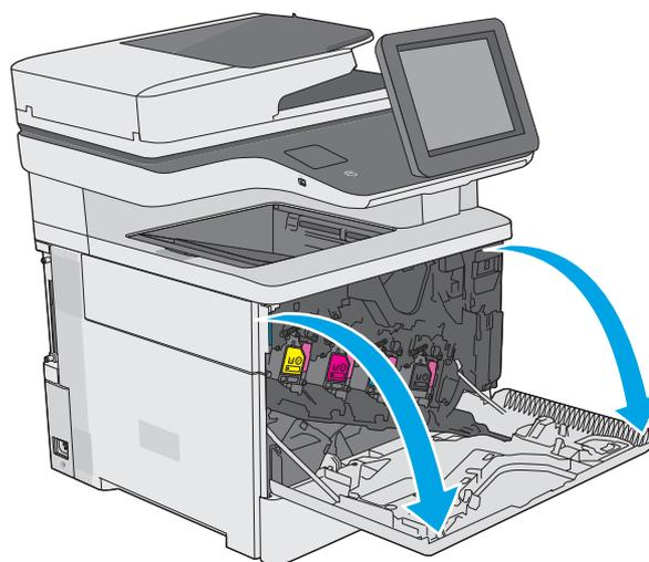
2. Abra a porta da unidade de coleta de toner na parte superior esquerda da impressora.
