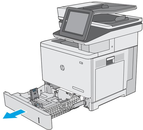
2. Antes de carregar papel, ajuste as guias de largura do papel apertando as travas de ajuste e deslizando as guias até o tamanho do papel que está sendo usado. A seta na guia da bandeja deve alinhar-se exatamente com a marca da bandeja.
