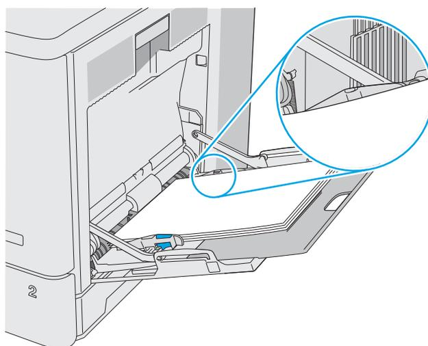
5. Ajuste as guias laterais de forma que toquem levemente na pilha de papel, sem dobrá-la.
