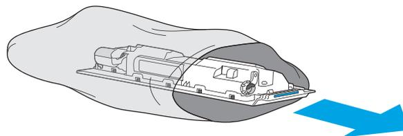
5. Instale a nova unidade de coleta de toner e a porta anexa na impressora. Alinhe as guias na porta com os slots na impressora.
